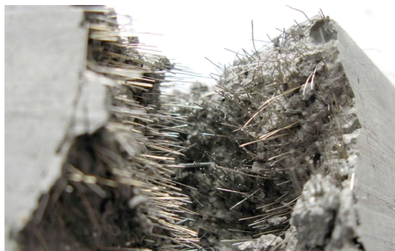
Bê tông cốt sợi.
